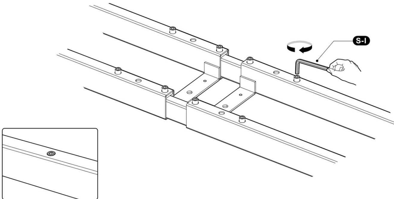
Vuelva a apretar los tornillos de cabeza hexagonal para finalizar el ajuste.
