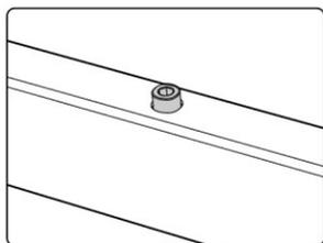
Sin llegar a retirarlos completamente, afloje los tornillos de cabeza hexagonal que fijan la unión ajustable.
