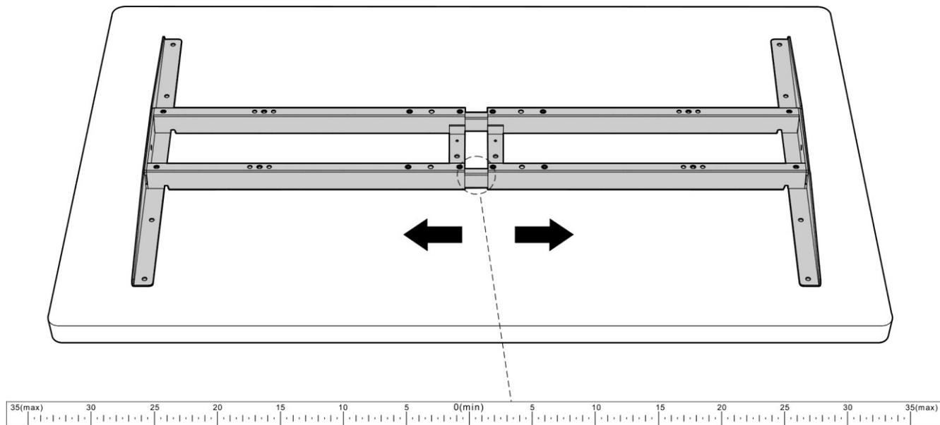
***Al ajustar la posición del marco, asegúrese de que no exceda la zona serigrafiada de la cara interna de la barra transversal.***
