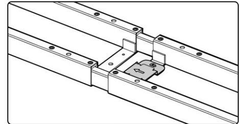
La placa de fijación se puede fijar en el lado derecho o en el lado izquierdo.
